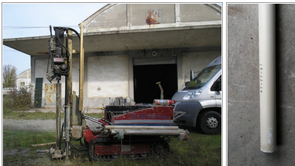
Foto 5.1 e 5.2 – A sx: attrezzatura per l'esecuzione dei sondaggi con tecnica "Geo-Probe". La foto riprende il carotiere d'acciaio al termine di una manovra d'estrazione nel punto di controllo S7-PZ4; a dx: fustella in materiale plastico, con all'interno i sedimenti campionati
